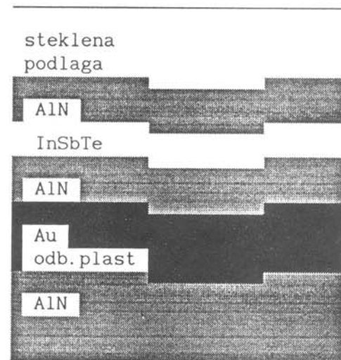
Slika 6. Struktura optičnega pomnilnika za večkratni zapis
