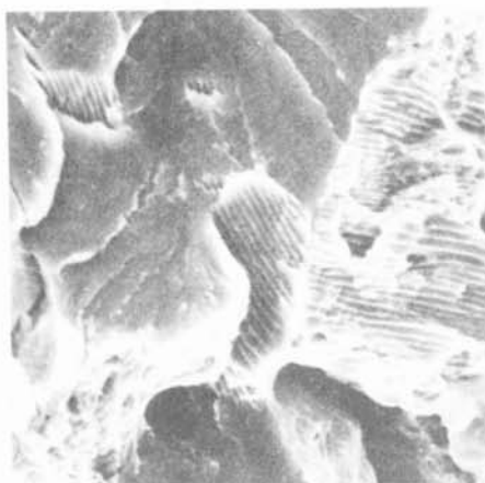
Posnetek inter- in transkristalnega preloma jekla s perlitno strukturo, P 10000x
