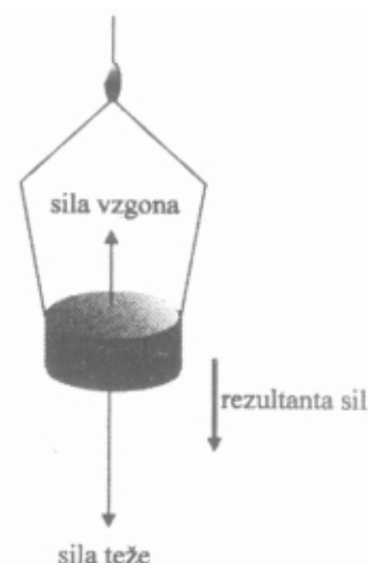
Slika 1: Sili, ki delujeta na lonček v statični atmosferi
