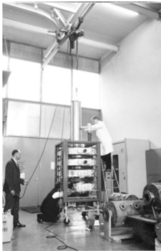
Montaža klistrona za 500 MHz za napajanje VF-rezonatorjev (RF cavity), Desy, spomladi 1964
