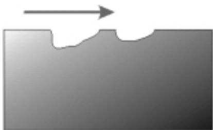
Slika 13: Prikaz erozijske korozije (4)
