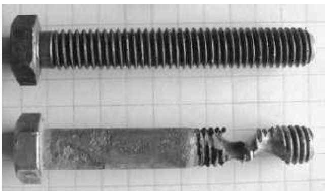
Slika 12: Prikaz korozije v špranji (4)
