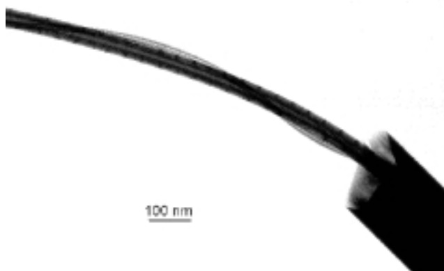
Slika 7: Prve anorganske nanocevke v Ljubljani: par nanocev \text{WS}_2 raste iz notranjosti mikrocevi. Ožja cev s premerom 18 nm se dovolj enakomerno ovija okoli debelejšje cevke premera 40 nm. Druženje obeh cev lahko razložimo s tvorbo vmesnih ploskev med kristalnima mrežama obeh cev. Stik med cevkami je možen le v točkah, kjer sta urejenost in orientacija sten skladna s prostorsko grupo P63/mmc (foto: Maja Remškar).
