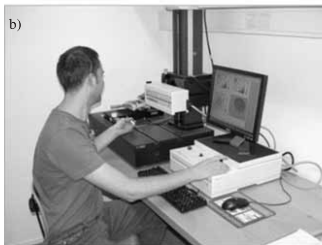
Slika 3: Princip delovanja 3D-profilometra z diamantno iglo (a) in posnetek naprave (b)
