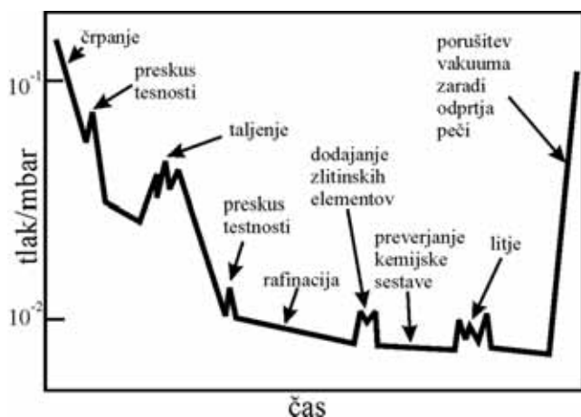
Slika 3: Spreminjanje tlaka v vakuumski komori vakuumske indukcijske peči pri taljenju nikljeve superzlitine
