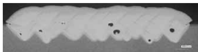
Slika 16: Dvoslojni navar na predhodno pretaljeni nitrirani površini
