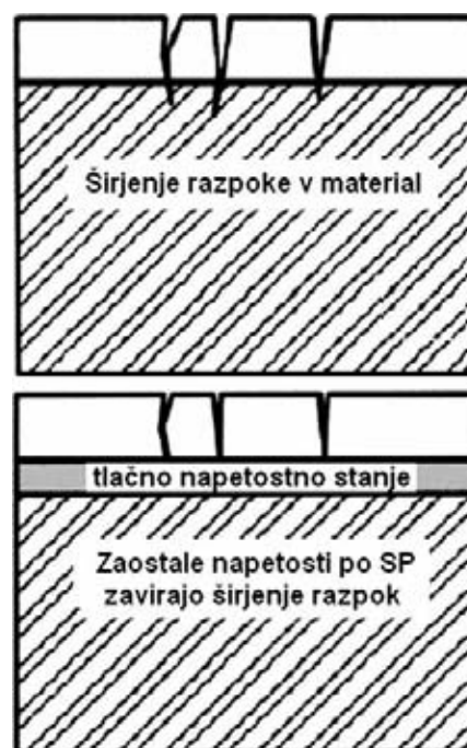
Slika 11: Preprečitev širjenja mikrorazpok z SP-obdelavo (1)
