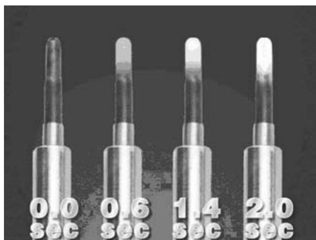
Slika 3: Delovanje keramične žarilne svečke glede na čas po vključitvi
