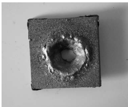
Slika 4: Velika moč koncentrirane svetlobe omogoča taljenje večine materialov, ki niso prozorni za vidno svetlobo. Na fotografiji je vzorec jeklene pločevine dimenzij 20 \text{ mm} \times 20 \text{ mm} \times 1 \text{ mm} po obdelavi z agresivno kisikovo plazmo. Sončna svetloba je bila fokusirana na sredino vzorca.
