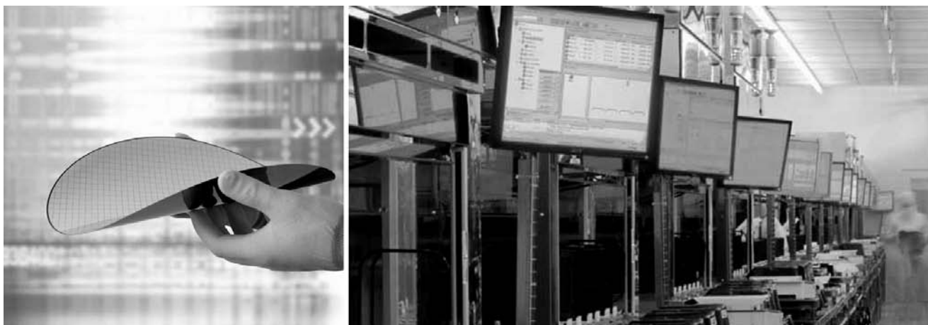
V oddelku podjetja INFINEON v Beljaku razvijajo elemente za močnostno elektroniko na fleksibilnih podlagah (levo) in nedavno so prvi na svetu uvedli proizvodno linijo za polprevodniške rezine premera 300 mm (desno).
