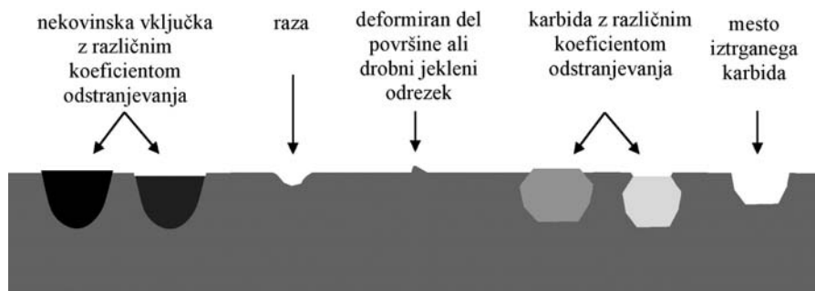
Slika 3: Shematski prikaz površinskih napak orodij, nastalih med poliranjem in brušenjem
