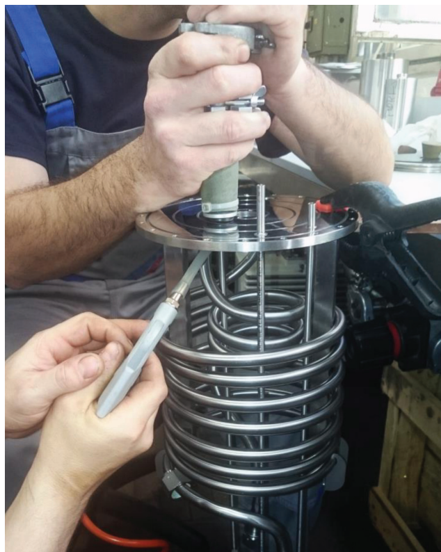
Slika 5: Odkrivanje netesnosti s helijem med postopkom izdelave komponente iz nerjavnega jekla
