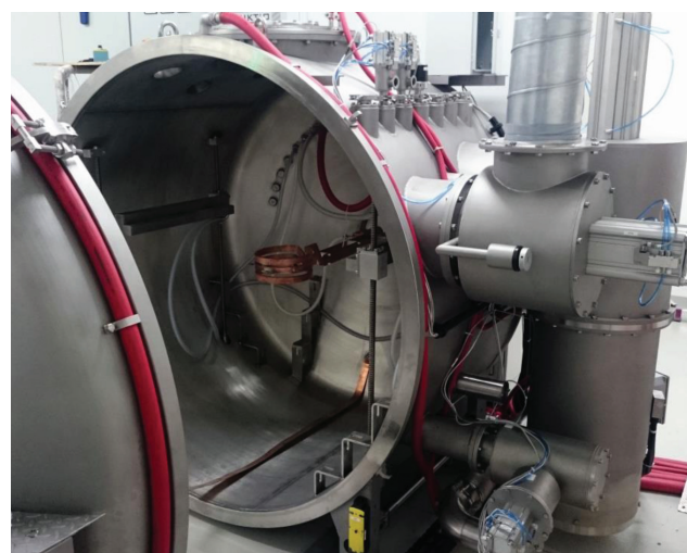
Slika 2: Vakuumska komora za taljenje specialnih oksidov v hladnem loncu. Na komori so nameščeni tudi namensko izdelani ventili in naša oljna difuzijska črpalka DN400.
